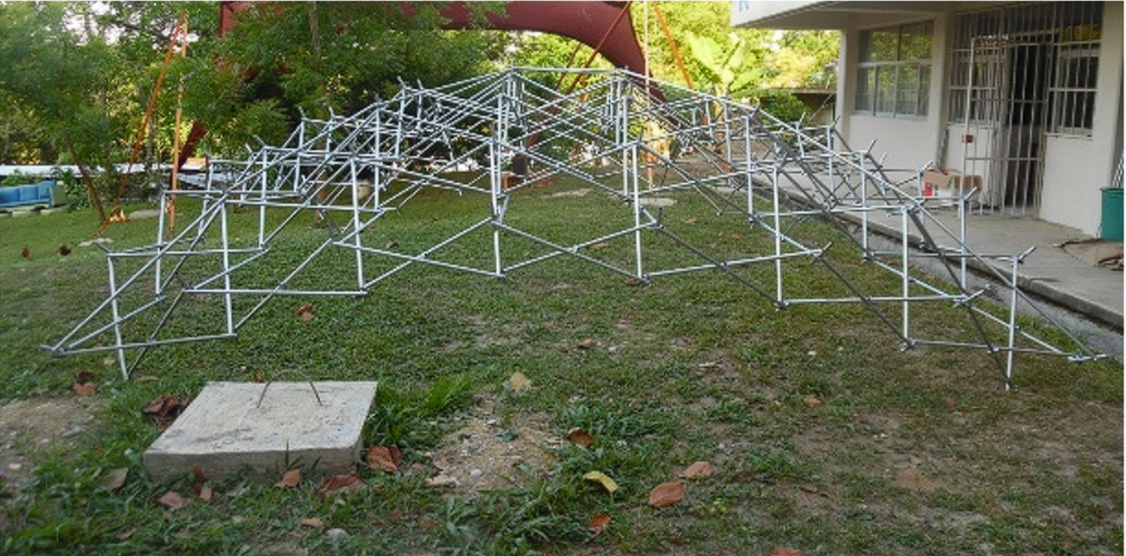
Figura 32. verificación del desplegado de la cubierta bidireccional. Fuente: Fotos experimentales (Morales, 2014).
