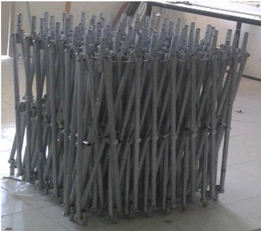
Figura 31. Las primeras dos imágenes muestran los dos nodos estándar que se realizaron para el modelo, las dos últimas imágenes el armado de los módulos de la cubierta. Fuente: Fotos experimentales (Morales, 2014).
