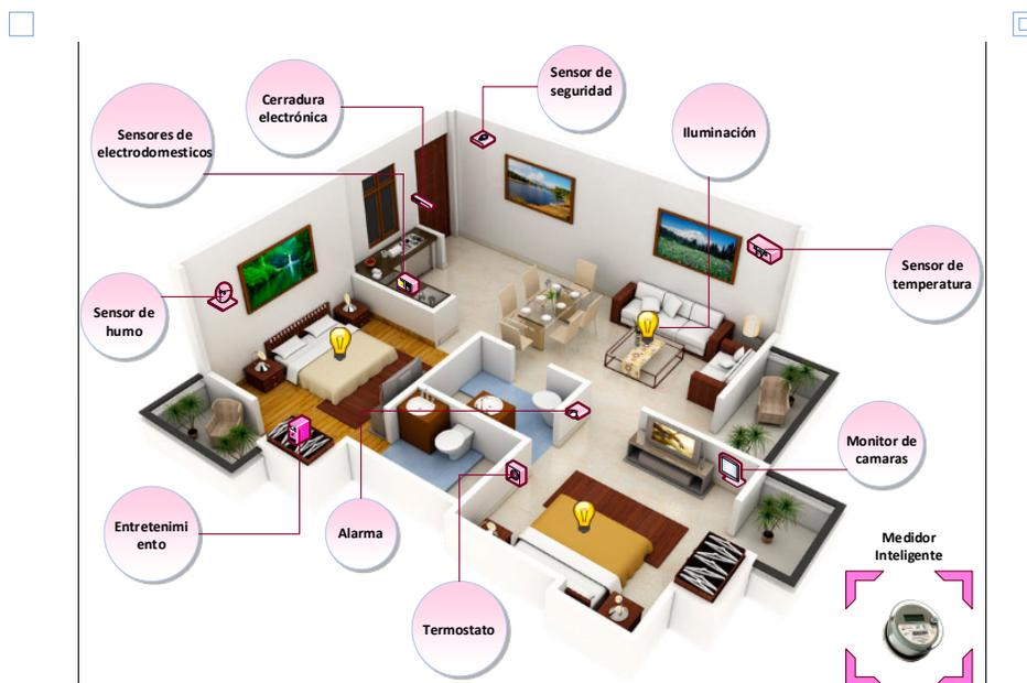
Fig. 2 Red de sensores inalámbricos para infraestructura de medición avanzada.
