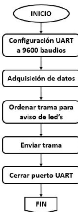
Fig. 9. Diagrama de flujo para enviar datos al aviso del LED.
