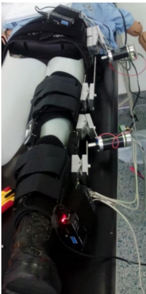
Fig. 9. Exoesqueleto desarrollado y plataforma para pruebas.
