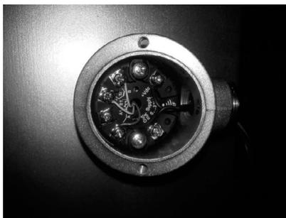
Fig. 6. Transmisor de temperatura Pixsys 69100 DIN.
