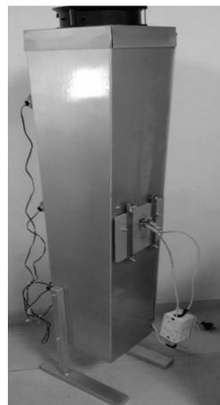
Fig. 1. Sección base del banco de pruebas con elemento calefactor soportado.
