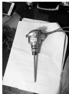
Fig. 5. Sensor de temperatura RTD Pt100.
