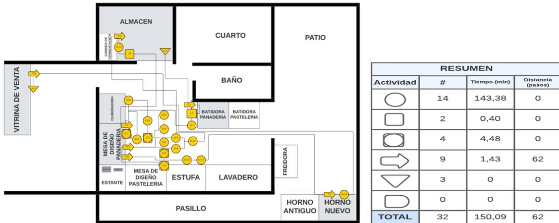
Figura 14. Simulación de diagrama de recorrido y tabla resumen del proceso con mejoras implementadas. Fuente: Elaboración propia.
