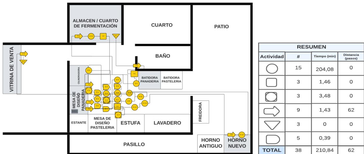
**Figura 3.** Diagrama de recorrido y tabla resumen del proceso de fabricación del Croissant. **Fuente:** Elaboración propia.
