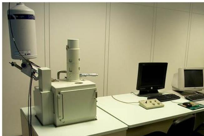
Figura 5. Microscopía de Barrido o SEM. Tomado de [23].
