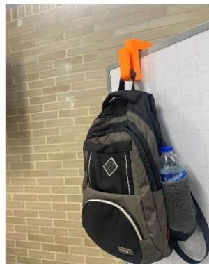
**Figura 15.** Prototipo funcional como soporte de bolso en baños. Fuente: Autoría.
