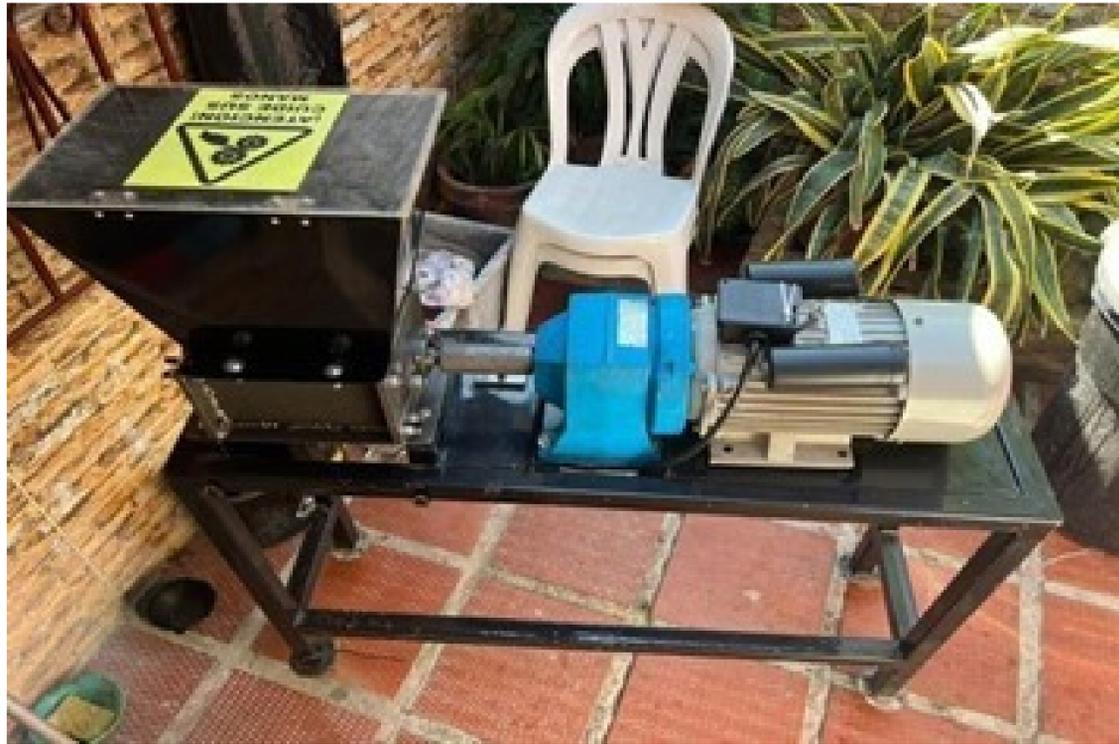
Fig. 19. Máquina trituradora ensamblada.
