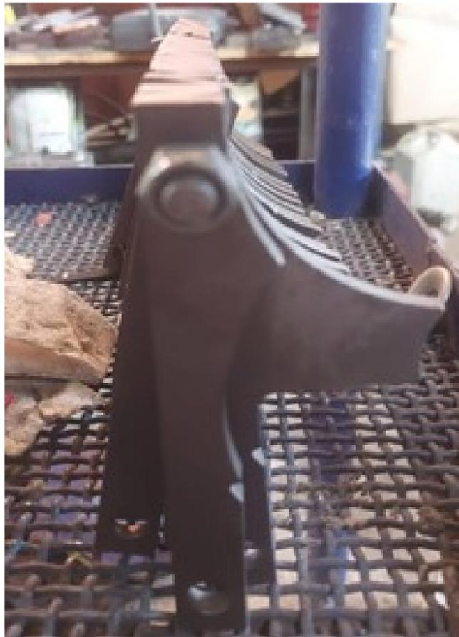
**Fig. 17.** Cuchillas fijas.
