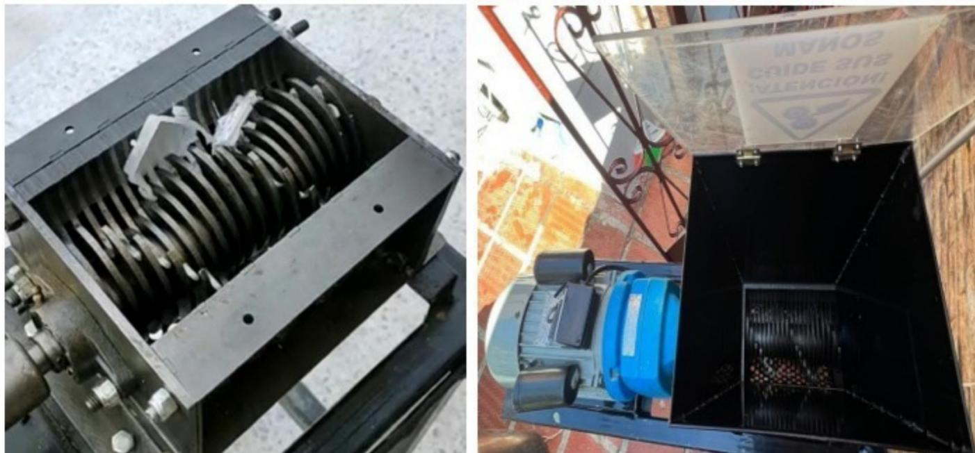
**Fig. 18.** Sistema de cuchillas de máquina trituradora.
