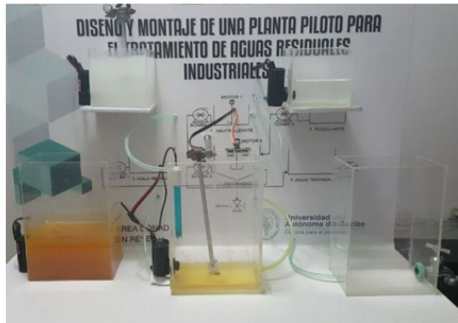
Fig. 9. Planta piloto para el tratamiento de aguas residuales industriales.
