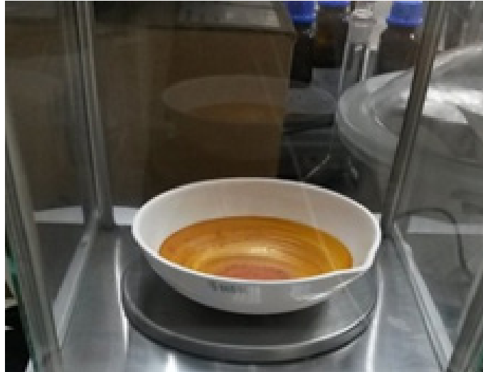
Fig. 1. Apariencia de los sólidos totales en la cápsula de porcelana. Fuente: Autores.
