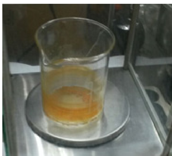
Fig. 4. Apariencia de los sólidos disueltos secos. Fuente: Autores.
