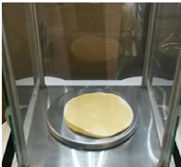
Fig. 3. Apariencia de los sólidos en suspensión secos en el papel filtro. Fuente: Autores.
